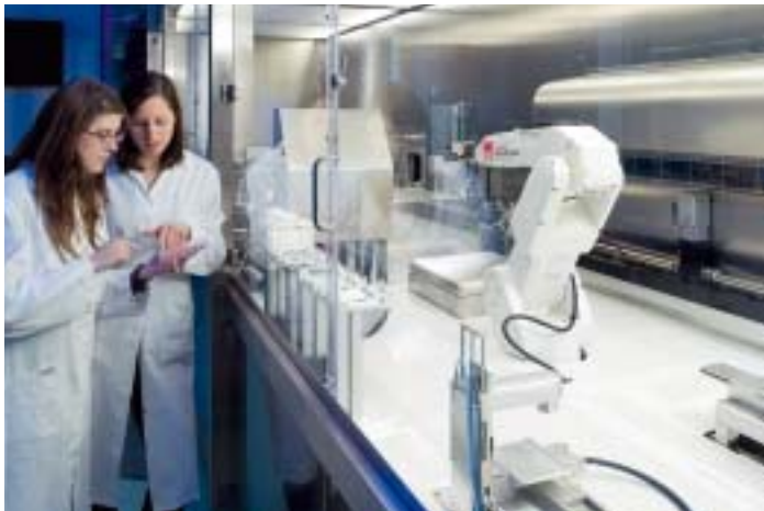
Tissue Fabrik: automatisierte Zell- und Gewebekultur zur Produktion von Epidermismodellen im Hochdurchsatz
