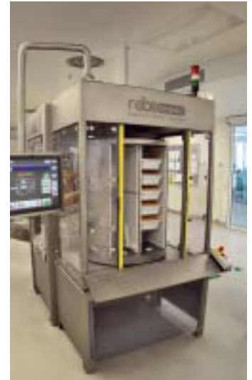
oben: Der Drehturm ist modular aufgebaut und kompakt
