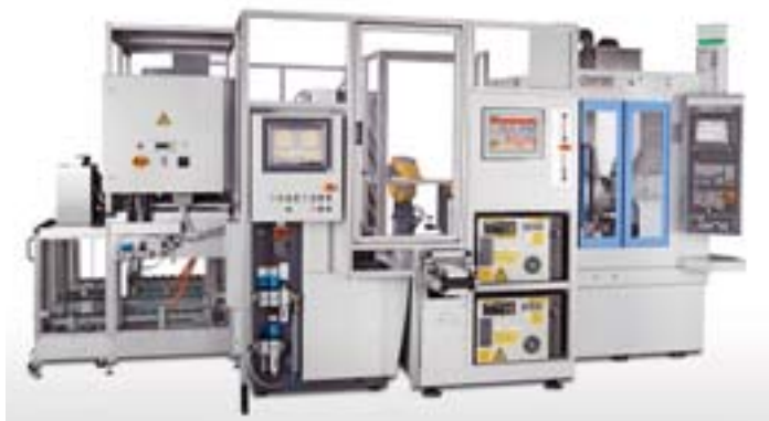
CHIRON FlexcellPro: Individuelle Automation durch kundenspezifische Zusatzapplikationen, z.B. Wuchten, Messen, 2D-Code-Lesen, Ausrichten usw.
