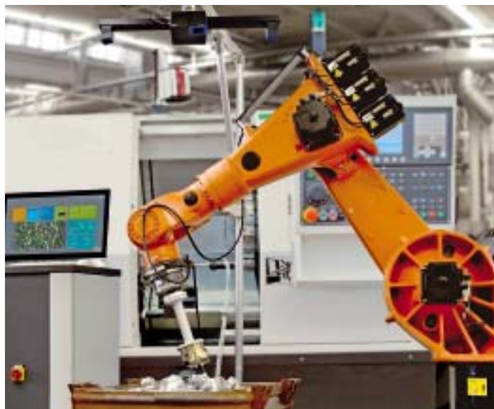
Automatisierte Schüttgutvereinzelung von sortenreinen Objekten mit dem SHAPE-SCAN3D
