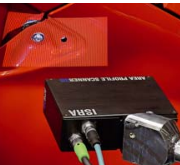
Automatische Vermessung von komplexen Objektgeometrien mit dem APS3D
