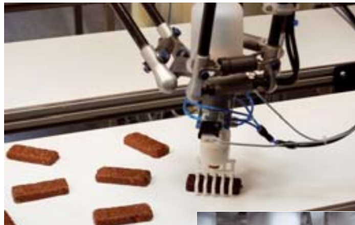
Praxisbeispiele Fruchtriegel-Picker (oben) und Eistüten-Abfüllanlage (rechts): Mit Laser-Sinteranlagen lassen sich Greiflösungen konzipieren, die individuell an das jeweilige Produkt angepasst sind (Bilder: LMD/Schunk)
