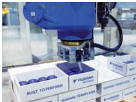
Beim Palletizing verlädt ein Hochgeschwindigkeits-Verpackungsroboter MOTOMAN MPK50 die vollen Trays auf eine Palette
