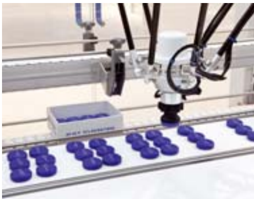
Den Picking-Vorgang übernehmen zwei Delta-Roboter MOTOMAN MPP3, die die Kunststoff-Taler aufnehmen, ausrichten und umsetzen
