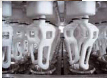
Praxisbeispiele Fruchtriegel-Picker (oben) und Eistüten-Abfüllanlage (rechts): Mit Laser-Sinteranlagen lassen sich Greiflösungen konzipieren, die individuell an das jeweilige Produkt angepasst sind (Bilder: LMD/Schunk)
