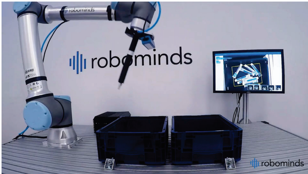
Robobrain von robominds – bin picking mit KI
