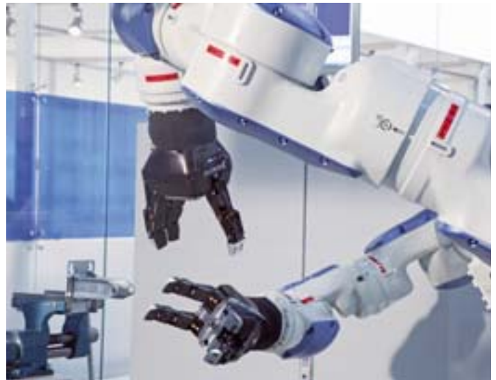
MOTOMAN SDA20D mit flexibel einsetzbaren Greifern und einer 3D-Bildverarbeitung. Kombiniert von der niederländischen ROBOMOTIVE, einem Systempartner von YASKAWA. (Quelle: YASKAWA)
