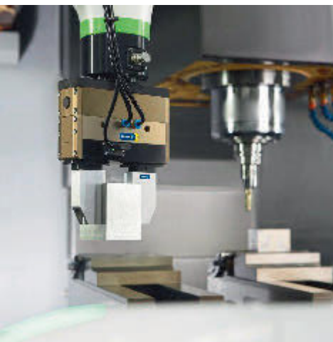
Der PGL-plus-P, ein pneumatischer Greifer mit zertifizierter sicherer Greifkrafterhaltung und integrierter IO-Link-Sensorik.
