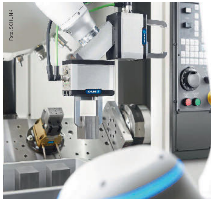
Elektrischer Universalgreifer EGU mit integrierter Greifkrafterhaltung und StrongGrip-Modus für erhöhte Greifkraft.
