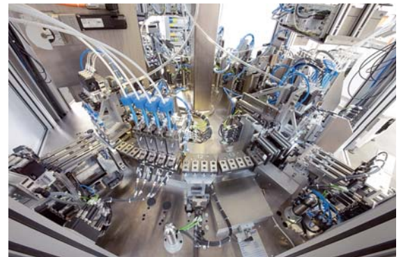
Teil einer Produktionsanlage für Dialysefilter mit Ultraschallschweißprozess und Integritätsprüfung (li.).
